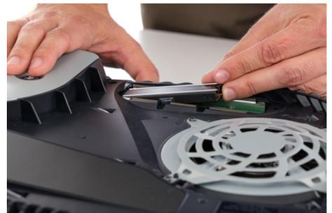
5. Anschliessend wird die SSD vorsichtig und gerade mit der Schraube fixiert.
