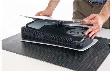
3. Mit einem Kreuzschlitz-Schraubenzieher der Größe 1 wird die Slot-Abdeckung zuerst entfernt und zur Seite gelegt.
