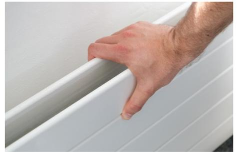
2. Zum Öffnen der PS5 stellt man die PS5 mit der Vorderseite zu sich hin, damit sich das PS5-Logo links befindet. Dann wird die Konsole nach links gekippt. Mit leichtem Anheben der linken hinteren Ecke kann der Deckel nach rechts geschoben und entfernt werden.
