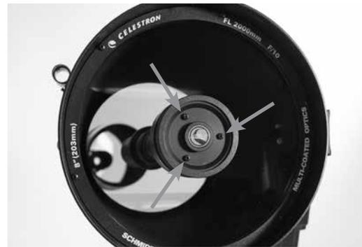
Vis d'ajustement de collimation du miroir secondaire
