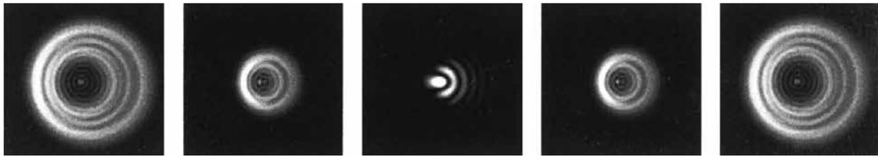
**Même si le motif d'étoile semble identique de chaque côté de la mise au point, il est asymétrique. L'obstruction d'étoile est déséquilibrée vers la gauche du motif de diffraction, cela indique une collimation incorrecte.**
