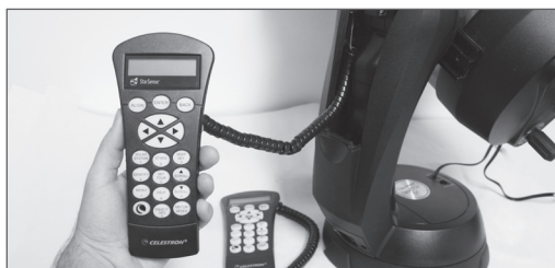
Die NexStar-Handsteuerung wird durch die StarSense-Handsteuerung ersetzt
