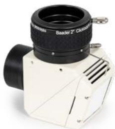
1. Entfernen Sie die 2" ClickLock® Okularklemme durch Lösen der sechs Innensechskant-Schrauben mit dem 1,3 mm Sechskantschlüssel. Es ist nicht nötig, sie vollständig herauszuschrauben. Der Filterhalter mit den Filtern bleibt im Herschelkeil montiert.
