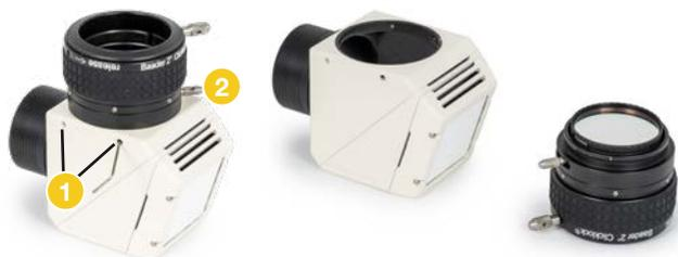
Lösen Sie die vier Schrauben im Gehäuse ① mit dem 1,5 mm Sechskantschlüssel, um Okularklemme und Filterhalter abzunehmen. Der Solar Continuum Filter wird teleskopseitig montiert, um Reflexionen zu vermeiden.
