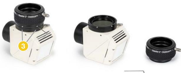
Lösen Sie die sechs Befestigungsschrauben ③ mit dem 1,3 mm Sechskantschlüssel, um die Okularklemme abzunehmen und z.B. einen Polfilter von oben in den drehbaren Filterhalter einzusetzen.
