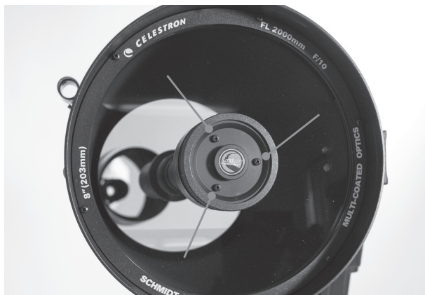
Kollimationsjustagen für den Sekundärspiegel
