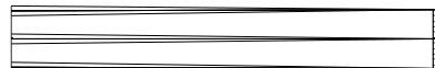
Strahlengang eines 6"-Refraktors, der mit einer Telezentrik auf f/30 verlängert wurde. (Das Licht kommt von links, dort ist auch die Telezentrik.)
