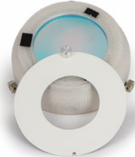
Ein D-ERF kann mit einer einfachen Blende abgeblendet werden.
