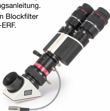
SunDancer II H-alpha-Filter mit Binokular-Ansatz und Zenitspiegel vor dem H-alpha-Filter.
